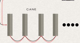
EG: A 1000W OUTPUT CHANNEL CAN POWER 20 SPEAKERS OF 50W EACH.
